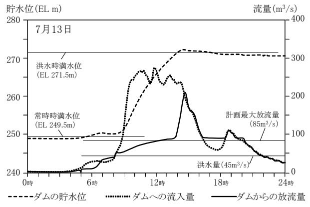
る。もし仮にただし書き操作を行わず設計高水位を超えてしまった場合、下流域では急激な水位上昇となるとともに、ダム堤体自体が破壊に至った場合には、下流域には激流が押し寄せることとなる。ただし書き操作の必要性は、このような下流域住民における最悪の事態を回避することにある。
