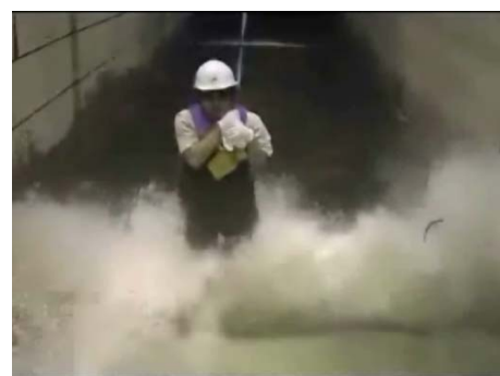
【動画-08】[0:37] 津波の破壊力に関する実験
