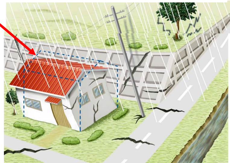
家がかたむく しゃめんや道路にひび割れ
